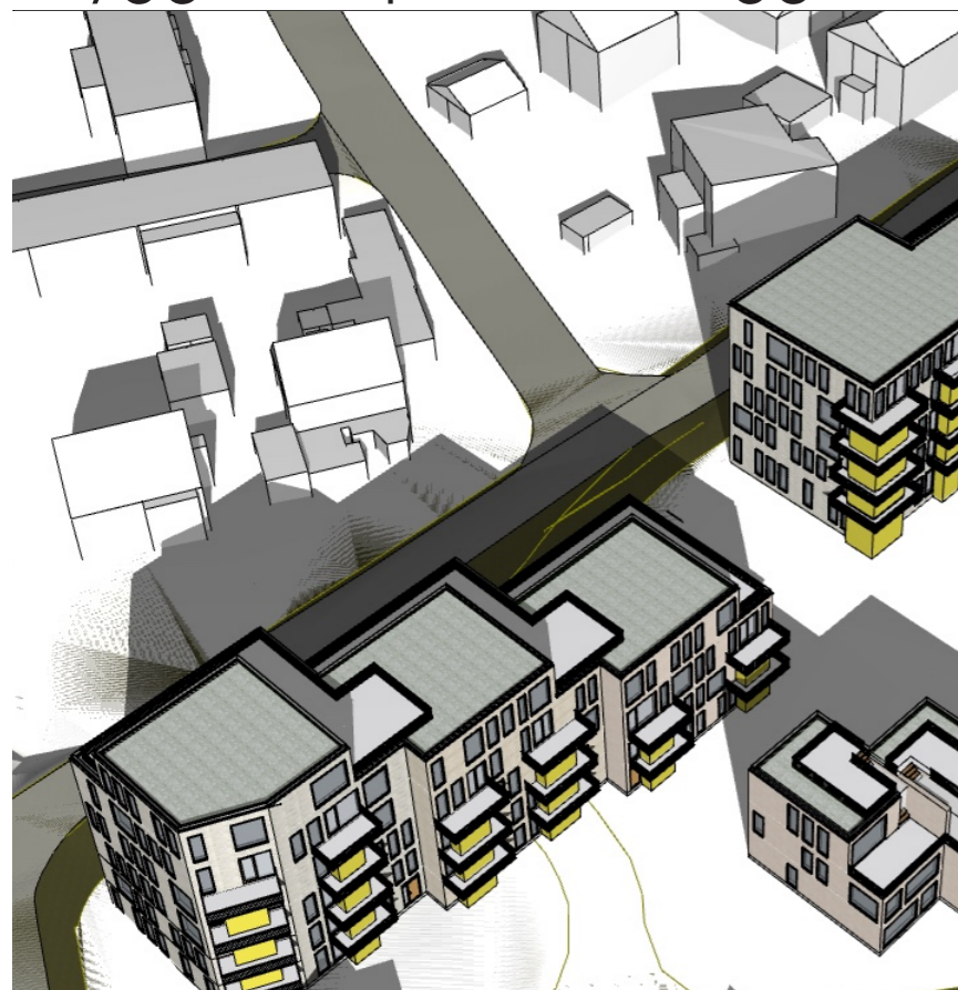
21.mars kl 15:00 -Utsatte veggflater på Zetlitzveien 4, 6, og 8.
