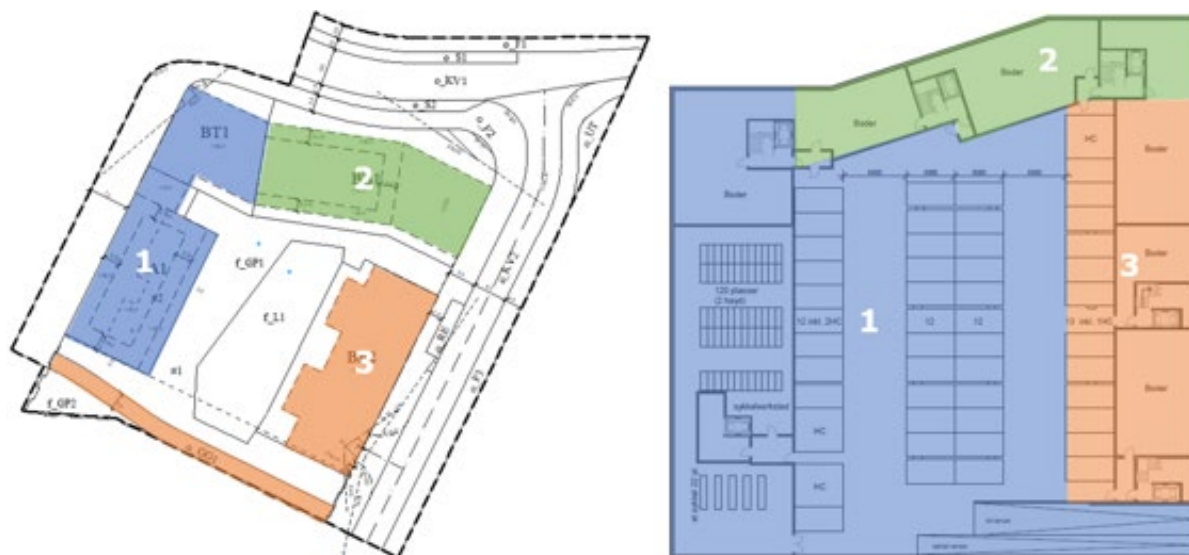
Figur 92 – Eksempel på inndeling av prosjektet i byggetrinn. Figuren til venstre viser inndelingen over bakkeplan, mens figuren til høyre viser inndelingen under bakken
