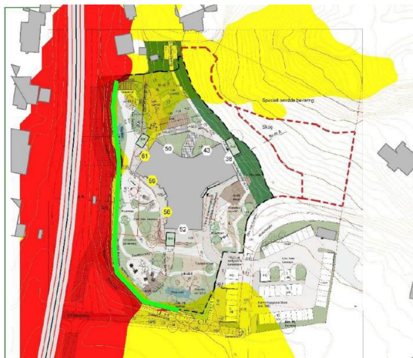
Figur 52: Kart som viser støynivå 1,5 m over terreng på uteoppholdsareal og mot fasade
