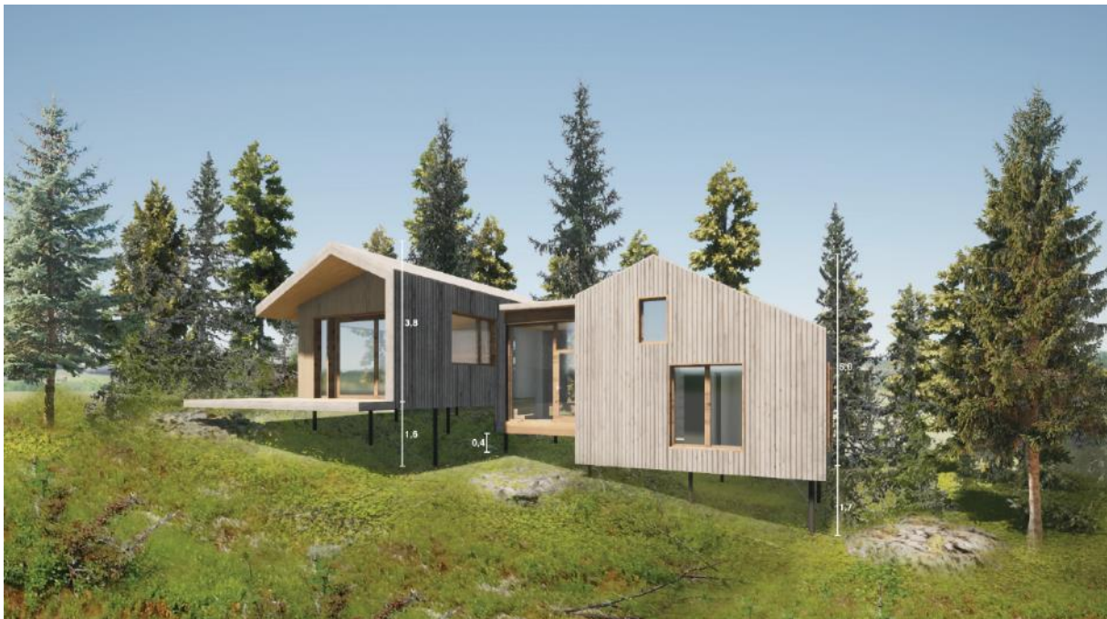
Figur 77 - 3D illustrasjon av hytte som er trappet for å tilpasses til terrenget
